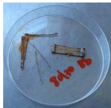
Fibre corrodibili, prova non superata
